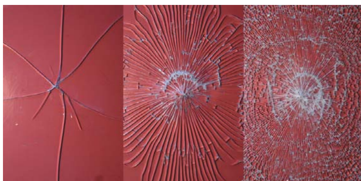
Εικόνα 1: Μορφή θραύσης γυαλιού. Από αριστερά ανοπτημένο, heat strengthened, toughened [6].
